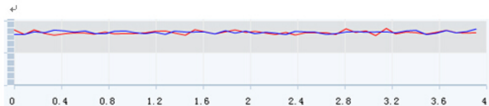
图五 样品 1 中加入 1% 的消泡剂后原子荧光测定信号图。
